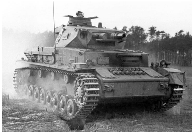
4. Kép: SdKfz 161 Panzerkampfwagen IV/ Panzer 4 német közepes harckocsi [11]
