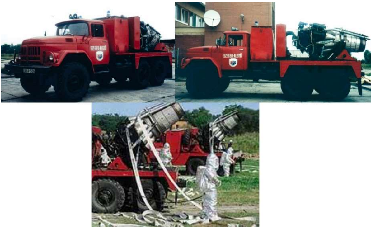
4. kép: A Zil-131 alvázra épített turboreaktív oltógépek [6]
