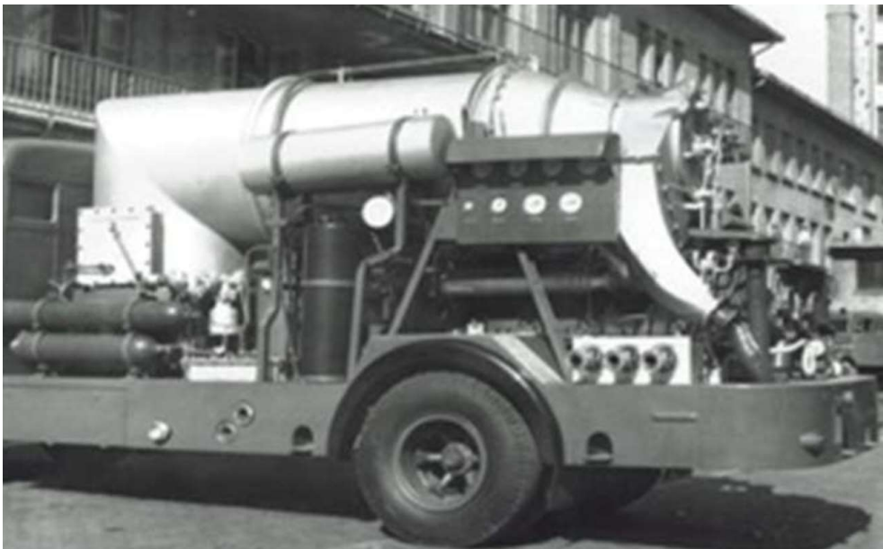
9. ábra: Szilvay-féle gázturbinás szárazoltó [33]
